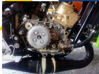
Gambar 3. Kerusakan pada Seal Water Pump
